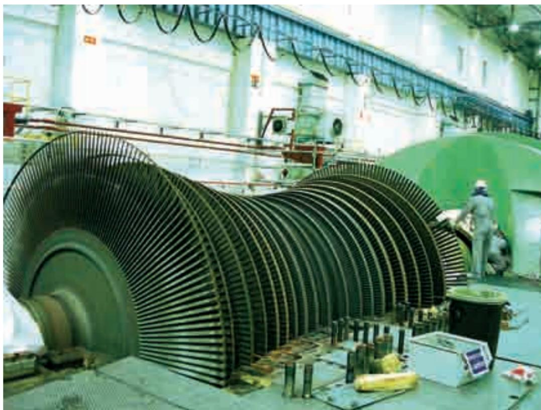
Pieza central de la turbina al descubierto. Habitualmente gira a 1.500 revoluciones por minuto. Pesa 120 toneladas y mueve el eje del generador para producir 466.000 kWh. de potencia eléctrica.
