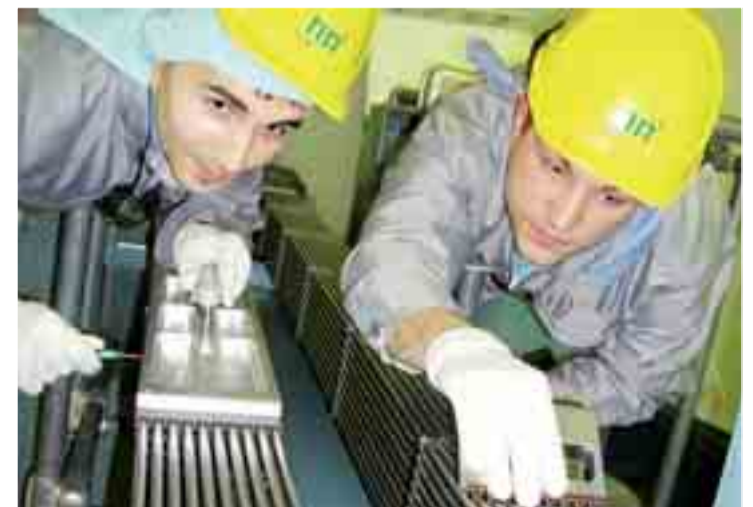
Profesionales inspeccionan el combustible durante la parada.
