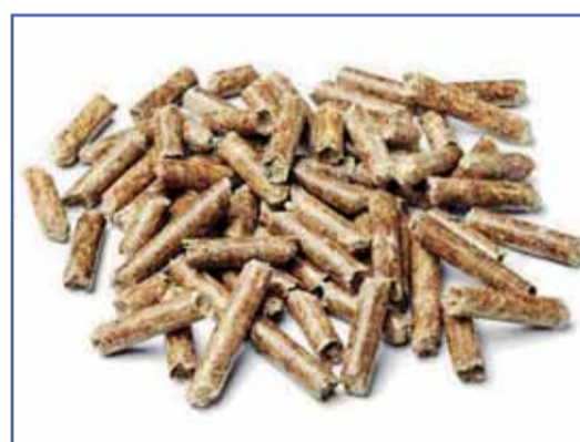
Pellets con los que funcionan las calderas.
