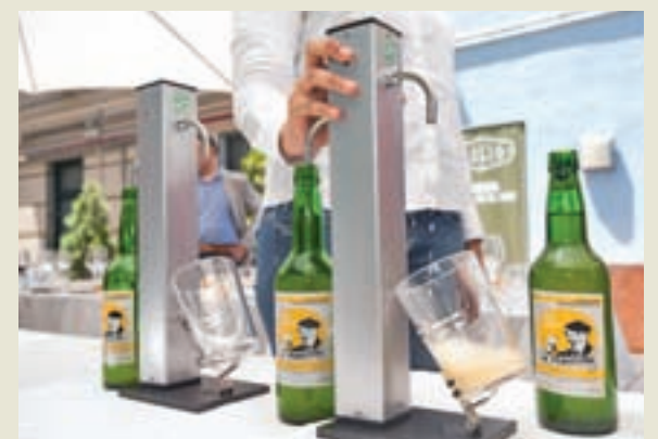
Escanciadores eléctricos de la sidra 'La Penúltima'
