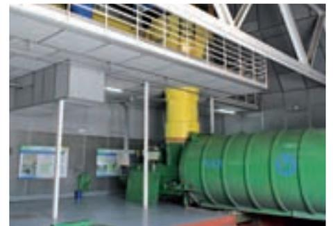
**4. Traslado:** Una plancha hidráulica mete la basura en el contenedor, y después se traslada. El olor y las partículas físicas que quedan se filtran antes de salir a la atmósfera.
