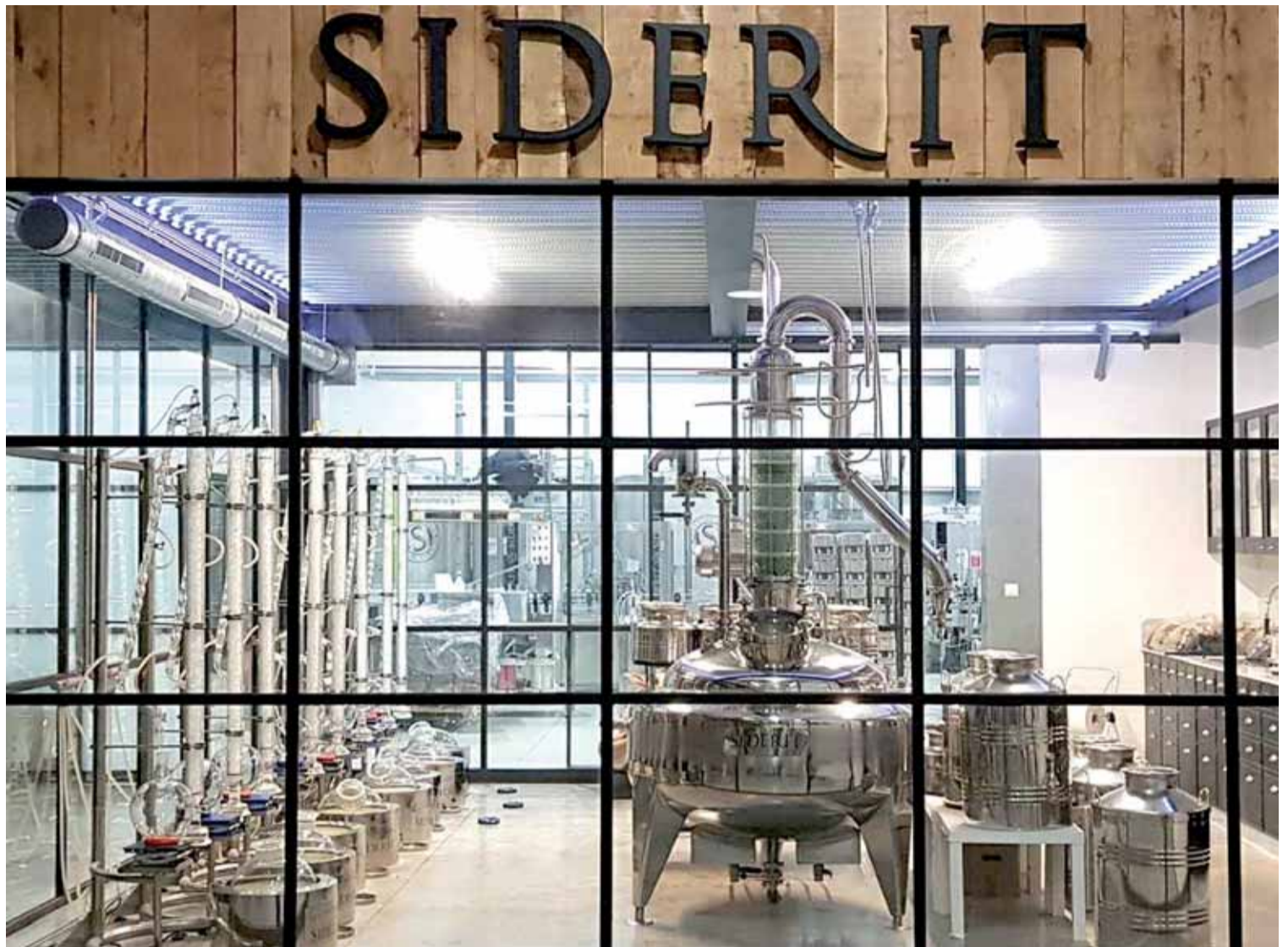
Los equipos de destilación de Siderit son únicos en el mundo. Construidos totalmente en vidrio, están fabricados en base a un diseño propio.
