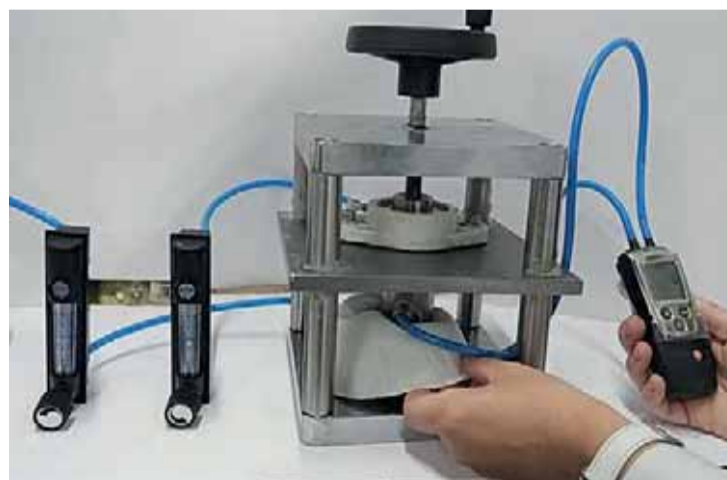
Proceso para comprobar si los tejidos y los filtros se ajustan a los requisitos exigidos.
