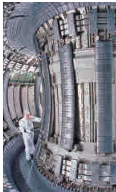
**ENERGÍA DE FUSIÓN:** El dispositivo JET, ubicado en Oxford, ha alcanzado un nuevo récord de energía de fusión de 59 megajulios durante 5 segundos. Se ha logrado fusionando deuterio y tritio.
